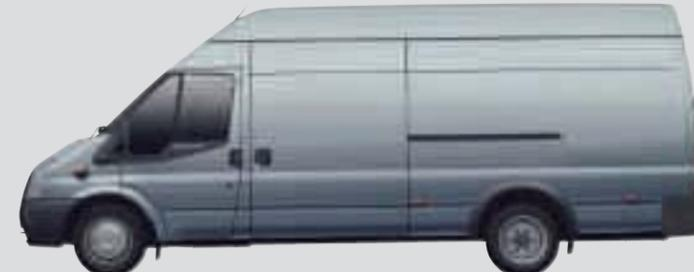
Длиннобазный фургон 'Jumbo' с двускатными задними колесами
