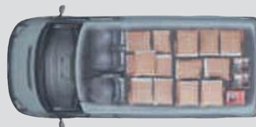
С двумя возможными вариантами высоты крыши (все цельнометаллические), среднебазный Ford Transit представляет собой очень практичный выбор. Максимальный объем грузового отсека в версии с высокой крышей – 10,3 м<sup>3</sup>, а грузоподъемность до 1673 кг.
